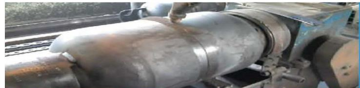
**SUB ARC FLUX : KFL - 333F****Aluminate -Basic Type**
